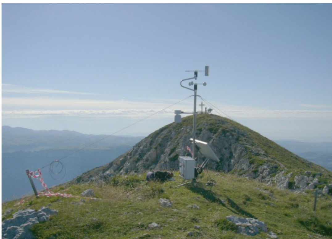
Figura 4.9. Sopralluogo del 04/08/2005: la stazione è in ottime condizioni, solo il nastro di segnalazione deve essere sostituito (veduta verso Est).
